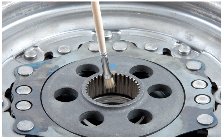
Bild 1: Die Innenverzahnung des ZMS sollte bei jeder Reparatur etwas befeuchtet werden
