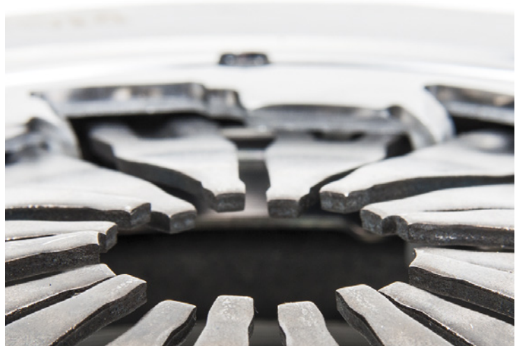
Bild 1: Versatz der Tellerfederzungen bei demontierter Kupplung
