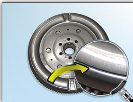
Bild 6: Motorseite mit umlaufender Vertiefung beim LuK ZMS
