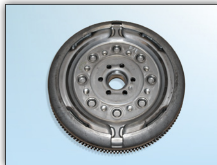
Bild 7: Motorseite ohne Vertiefung beim Sachs ZMS
