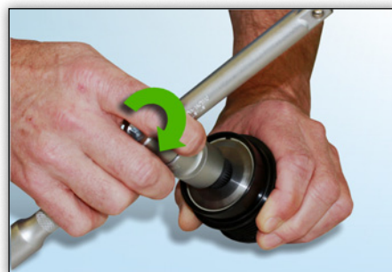
Bild 7: Im Uhrzeigersinn lässt sich das Werkzeug mit leichtem Widerstand uneingeschränkt verdrehen.
