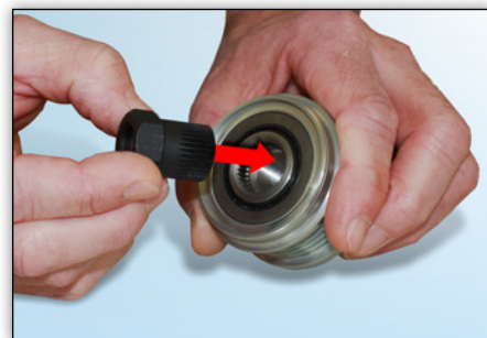
Bild 3: Den entsprechenden Adapter in die Freilaufriemenscheibe einsetzen.
