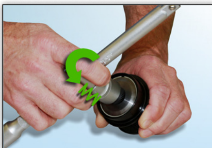
Bild 6: Gegen den Uhrzeigersinn spürt man eine deutlich ansteigende Federkraft.
